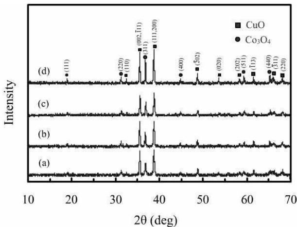
**Figure 4.** XRD patterns of  $\text{Co}_3\text{O}_4/\text{CuO}$  nanopowders at different calcination temperatures (a)  $550^\circ\text{C}$ ; (b)  $600^\circ\text{C}$ ; (c)  $650^\circ\text{C}$  and (d)  $700^\circ\text{C}$ .
